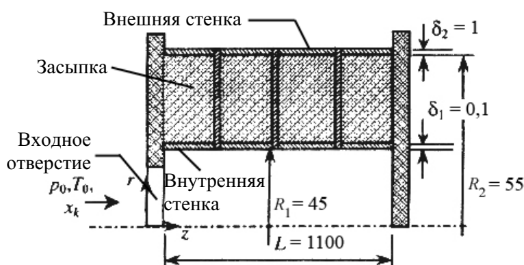
Рис. 24. Схема реактора, использованная в расчетах (размеры в миллиметрах)
